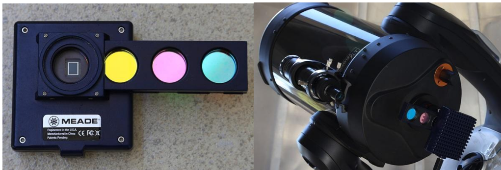
Figura 1: Câmera CCD com filtros LRGB usada na obtenção de astrofotografias e sua devida montagem ao telescópio.
