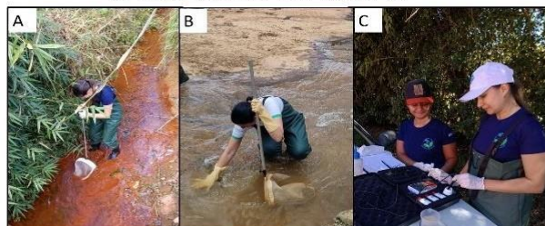
Figura 02 - A e B) Coleta de macroinvertebrados bentônicos. C) Coleta de variáveis físico-químicas da água in situ .
